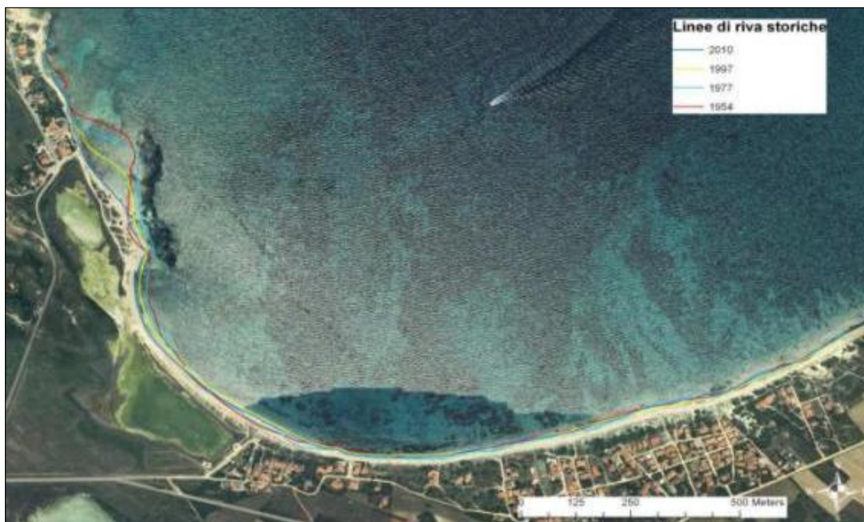
Figura 24 - Variazioni della superficie di spiaggia dal 1954 al 2010, tratto dal progetto "Interventi urgenti per la messa in sicurezza dei tratti di maggior rischio e alla mitigazione degli effetti delle dinamiche erosive nei punti di maggior intensità e incidenza nella linea costiera".
